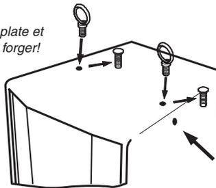
N'enlevez pas les boulons à tête plate sur le côté de l'enceinte/s
