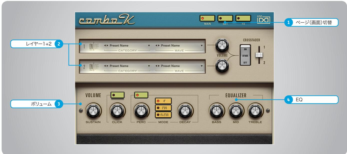
操作画面は上下2つのセクションに分割されます。画面上段では2つのレイヤー（音色）を設定して演奏することができます。この2つのレイヤーは完全独立し、それぞれ専用のボリュームが用意されています。また2つのレイヤーを徐々に変化させるクロスフェーダー（MIDIアサイン可能）も装備します。このことでボリュームペダルやモジュレーションホイールなどで音色の切替え、例えば2つの異なる速度のロータリー効果を含んだレイヤーをスムーズに変化させる際に便利です。画面下段はレイヤーのより細かな調節（サスティン、リリース、パーカッション）やEQが用意されています。
