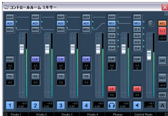
コントロールルームミキサー - すべてのシグナルプレゼンスインジケータが点灯
