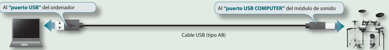
**\* Si su módulo V-Drums no dispone de la función de audio USB, conecte un cable de audio desde la "salida de audio" del ordenador al "conector MIX IN" del módulo de sonido V-Drums.**
