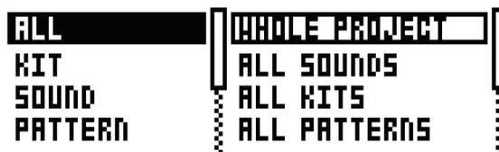
左の列では、バックアップする内容を選択します。**[LEFT]** 矢印キーを使用して、列を選択します。**[UP]/[DOWN]** の矢印キーまたは **LEVEL** ノブを使用して、列をスクロールします。右側の列に配置された送信される SysEx データの選択肢は、左の列での選択に応じて変化します。**[RIGHT]** 矢印キーを押して、この列にアクセスします。**[UP]/[DOWN]** の矢印キーまたは **LEVEL** ノブを使用して、送信される内容を選択します。**[YES/SAVE]** キーを押して、SysEx の送信手続きを開始します。
