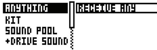
左の列では、受信する内容を選択します。[LEFT] 矢印キーを使用して、列を選択します。[UP]/[DOWN] の矢印キーまたは LEVEL ノブを使用して、列をスクロールします。右側の列の、受信する SysEx データの選択肢は、左の列での選択に応じて変化します。[RIGHT] 矢印キーを押して、この列にアクセスします。[UP]/[DOWN] の矢印キーまたは LEVEL ノブを使用して、受信する内容を選択します。[YES/SAVE] キーを押して、SysEx の受信手続きを開始します。Analog Rytm は、受信データのリスニングを開始します。[NO/RELOAD] キーを押して、リスニングを停止します。
