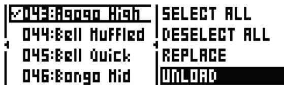
RAM 内のサンプルは個々に置き換えることができます。置き換えたいサンプルを含むスロットをハイライト表示してから、**[RIGHT]** 矢印キーを押して右側のメニューを表示し、**REPLACE** を選択します。+Drive のディレクトリをブラウズし、希望のサンプルを選択して **[YES/SAVE]** を押すと、そのサンプルと前の手順でハイライト表示したサンプルが置き換えられます。+Drive ストレージのディレクトリのブラウズに戻りたい場合は、**[LEFT]** キーを 2 回押してから **VIEW +DRIVE** を選択します。
