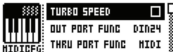
**TURBO SPEED** : **[YES/SAVE]** キーを押して、ターボスピードネゴシエーションを開始します。速度は自動的に選択されます。
