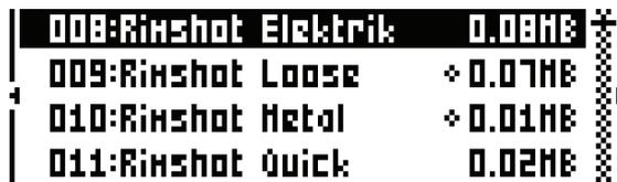
この画面で、127 のユーザーサンプルを個々にアンロードしたり、スロットを空にするためにまとめてアンロードしたりできます。**[ARROW]** キーの **[UP]/[DOWN]** または **LEVEL** ノブを使用して、リストをスクロールします。**[YES/SAVE]** キーを押して、個々のサンプルにチェックを付けるか、**[RIGHT]** 矢印キーを押して右側のメニューを表示し、**SELECT ALL** を選択します。右側のメニューで、**UNLOAD** を選択してチェックされたサンプルのスロットを空にします。
