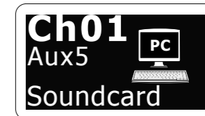
Exemple : La voie 1 est nommée 'Soundcard' et utilise le signal d'entrée Aux input 5
