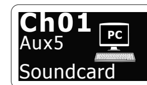
Ejemplo: El canal 1 tiene el apodo 'Soundcard' y recibe la señal desde la entrada auxiliar 5
