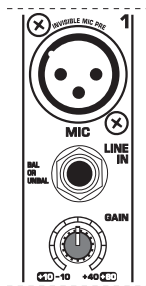
Fig. 2.1: Conexiones y reguladores de las entradas mic/line
