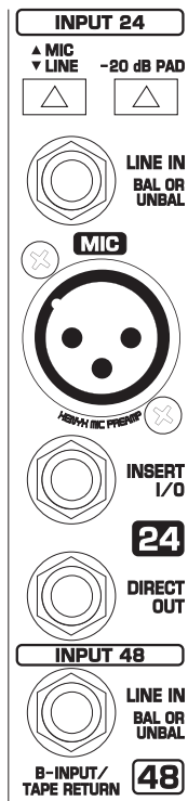
図. 7.8: A および B チャンネル入力セクション
