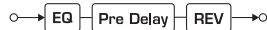
図 4.4: アンビエンス、ゲートリバーブ、リバーブスリバーブエフェクトの構造
