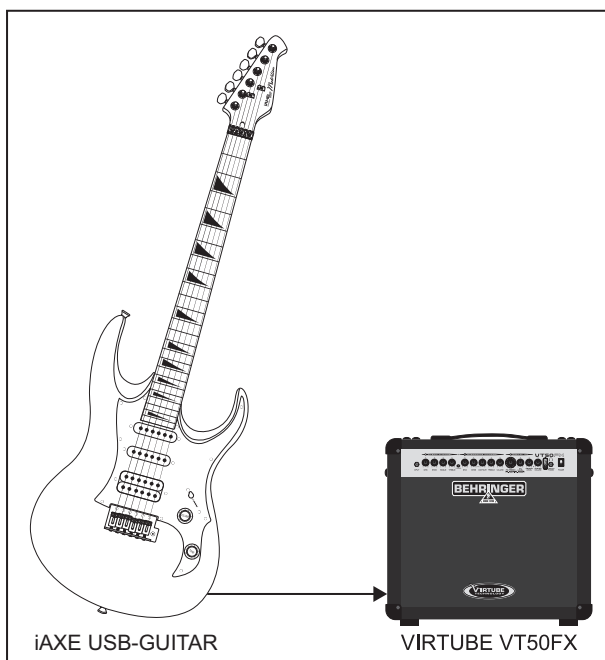
Abb. 4.2: Anschluss an einen Gitarrenverstärker
