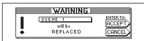
Kuva 12.4: WARNING, kun halutaan kirjoittaa SNAPSHOT-muistipaikkojen päälle
