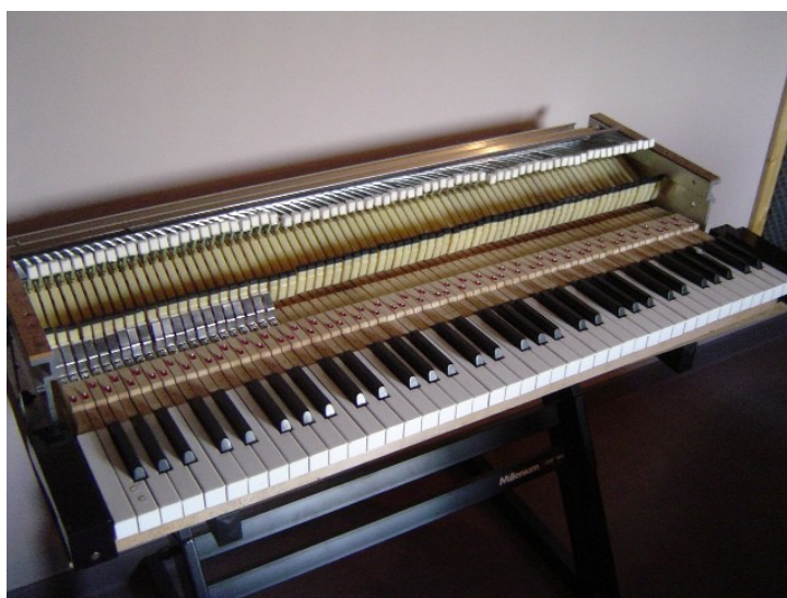
A l'intérieur du Wurlitzer EP-200A
