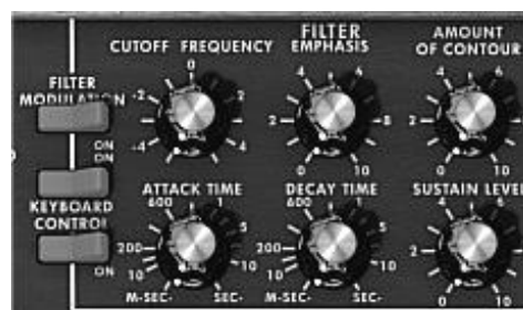
The filter settings of the Mini V
