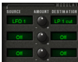
ローパス・フィルターの cutoff フリケンシー (LP1 cutoff) を LFO で変調
