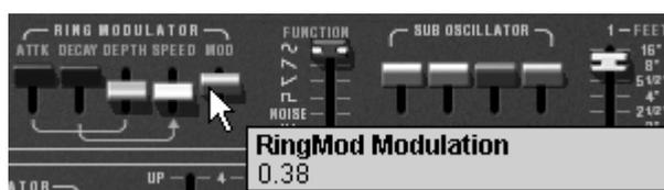
*Réglage «Modulation» du Ring Modulator*
