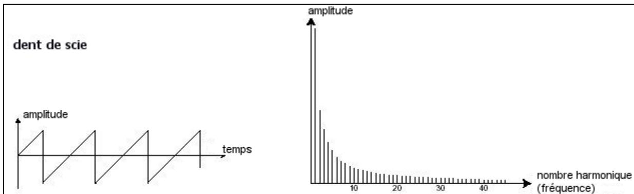
Représentations temporelle et spectral d'un signal dent-de-scie
