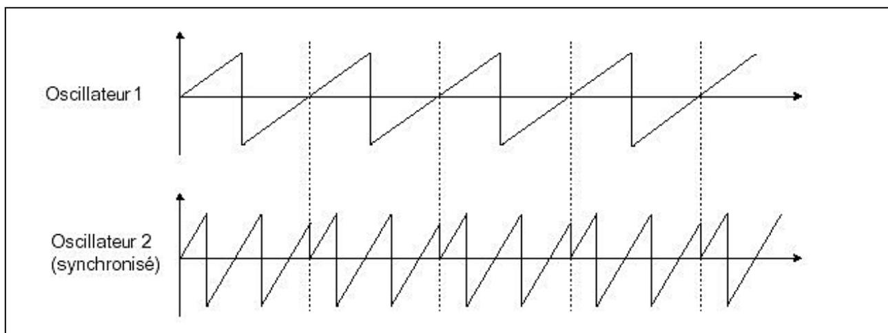
*L'oscillateur2 est synchronisé sur le premier puis accordé sur une fréquence de tonalité double. La forme d'onde résultante est unique et ne saurait être recrée par des techniques de base de la synthèse, telles que la superposition ou le filtrage.*
