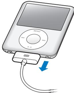
Si el conector del Dock es más grande que el que se muestra en la imagen, presiónelo por ambos lados para extraerlo.
