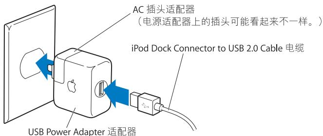
**【警告】**请确定在将电源适配器插入电源插座之前，适配器已完全组装好。
