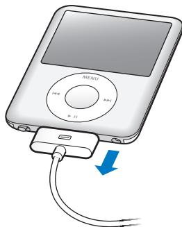
如果 Dock 接头比图示的大，请先挤压接头的两侧，然后再拔下它。
