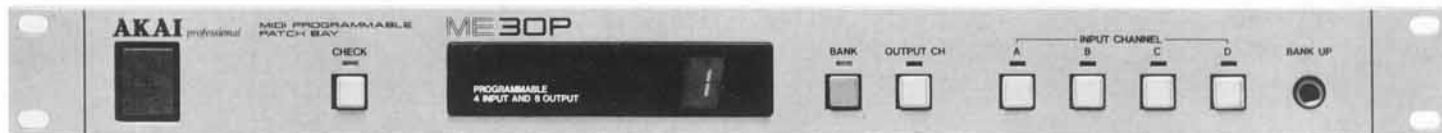
Dispatching programmable de réseau MIDI, 4 entrées, 8 sorties, 15 mémoires de configuration.
