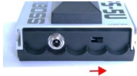
Los pedales FS-5U son conectados en los puertos 1-2 y 3-4 del BT-105/DIGIT. Para mayor información de uso, vea en el manual las secciones para el BT-105/DIGIT.
