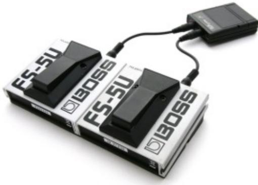
El BT-105 o DIGIT puede ser utilizado con uno o dos pedales BOSS FS-5U. Se requiere de cables especiales de su proveedor de AirTurn y estos les son provistos cuando lo adquiere como un kit. Para una mayor comodidad en el uso del FS-5U, puede deslizar los dos interruptores juntos.
