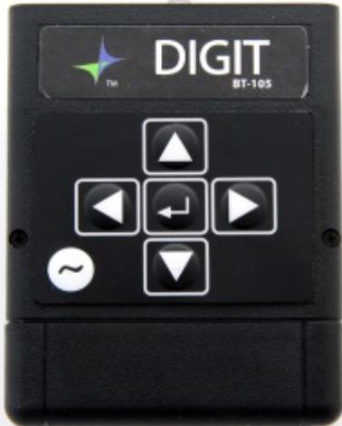
configuraciones. Ofrece un teclado con 6 interruptores. Los interruptores también se utilizan para cambiar el modo de la unidad y enviar caracteres diferentes en cada modo. El DIGIT también puede utilizarse con hasta cuatro interruptores momentáneos, con interruptores de lengua o de mordida y en toda una serie de entornos. (Por favor, consulte BT-105
