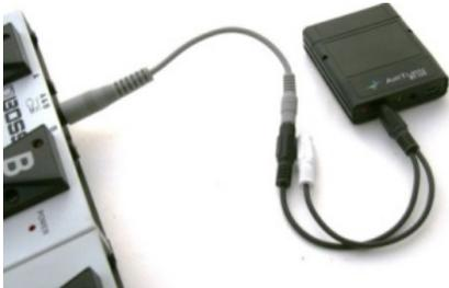
Presione el pedal A. Encienda el BT-105. Tan pronto como vea al BT-105 parpadear en color verde, suelte el pedal A y el interruptor de encendido.
